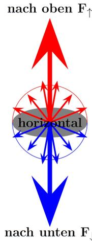
Diagr. 1: Erläuterung der Zweistromnäherung
